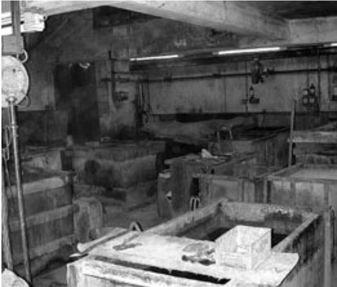
«Schlechtes» Beispiel eines Galvanisierbetriebs aus dem Jahr 2003, wo die Bäder nicht dem Stand der Technik entsprechen.
